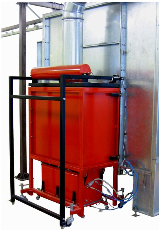
В установках, оснащенных откатным блоком фильтрации с вибрлотком, порошок, отряхиваемый с фильтрующих элементов, попадает через лоток с вибратором в емкость (коробка, мешок и т.п.). Для возможности повторного использования порошка, собранного системой рекуперации, его необходимо просеивать на вибросите. Такая конструкция системы рекуперации обеспечивает максимальную легкость очистки оборудования и удобство в эксплуатации при частой смене краски.
